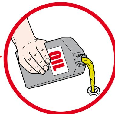
**Warnung!** Die Maschine wird ohne Öl im Untersetzungsgehäuse geliefert. Nachfüllen!
