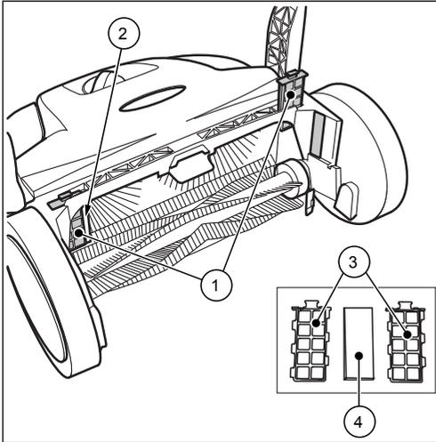
**Fig. 12: Extracción de los filtros de polvo**
