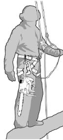
Die Motorsäge sollte vom Arbeiter am Boden kontrolliert, aufgetankt, gestartet und vorgewärmt werden, dann ist sie auszuschalten, bevor sie dem Benutzer auf dem Baum erreicht wird.
