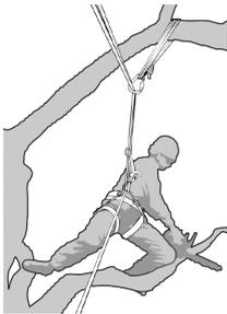
Wenn die Bediener sich jedoch vom Stamm entfernen, müssen sie versuchen, die wachsenden Abdrängkräfte zu annullieren oder zu neutralisieren, beispielsweise indem sie die Richtung des Hauptseils mit Hilfe eines zusätzlichen Verankerungspunkts ändern oder einen einstellbaren Flachriemen direkt am Gurtwerk an einem zusätzlichen Verankerungspunkt verwenden.
