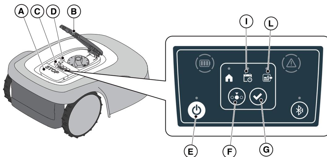
REMARQUE : le robot tondeuse peut être utilisé en mode « **CYCLE DE TRAVAIL UNIQUE** » même sans effectuer la programmation des heures de travail via l'appli. Ce mode pourrait ne pas garantir une couverture totale du jardin, tant en termes de temps nécessaire que d'uniformité du résultat de la coupe, surtout si le jardin n'a pas une forme régulière. Pour obtenir une efficacité maximale du robot tondeuse, il est recommandé d'effectuer la programmation (voir le paragraphe 4.7).
