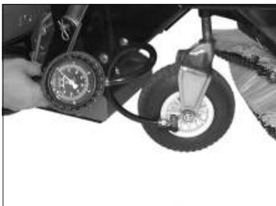
Stabilisateur : 2 bars. Sur des pavés, la pression peut être descendue à 1,5 bar.
