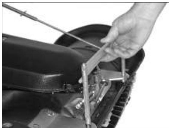
2) Dispositif de verrouillage en position arrière.
