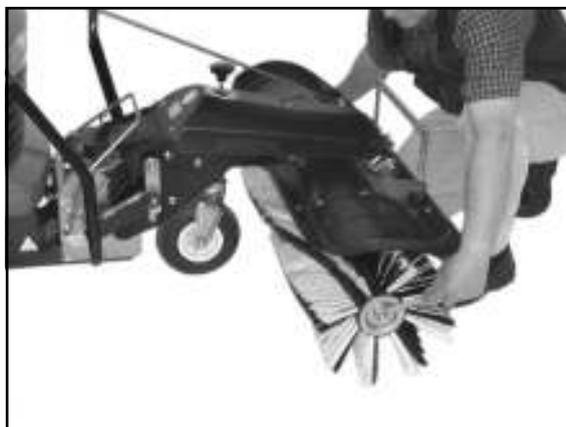
10) Fixer maintenant les brosses de balayage avec l'écrou de blocage. (maintenir l'écrou à l'autre extrémité de l'axe)
