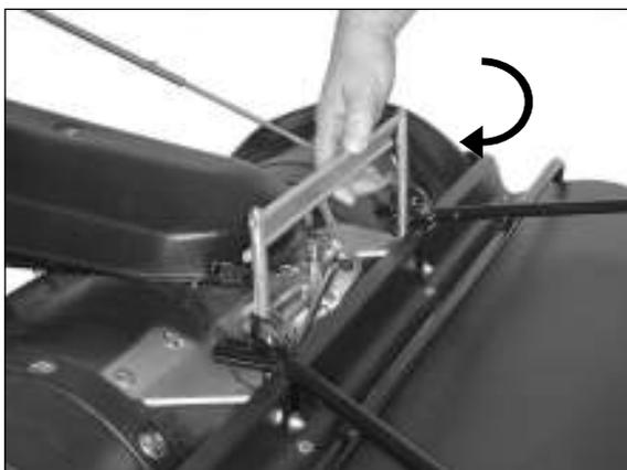
5) Basculer le dispositif de verrouillage vers l'avant.
