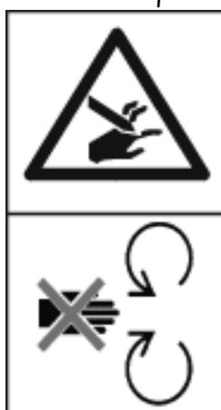
Ne pas ouvrir le dispositif de protection, risque d'écrasement
