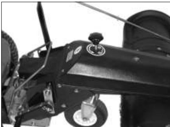
3) Pression optimale des brosses : abaisser la brosse jusqu'à ce qu'elle touche juste le sol. Ensuite, tourner encore 3 fois dans le sens inverse des aiguilles d'une montre dans la direction (-).
