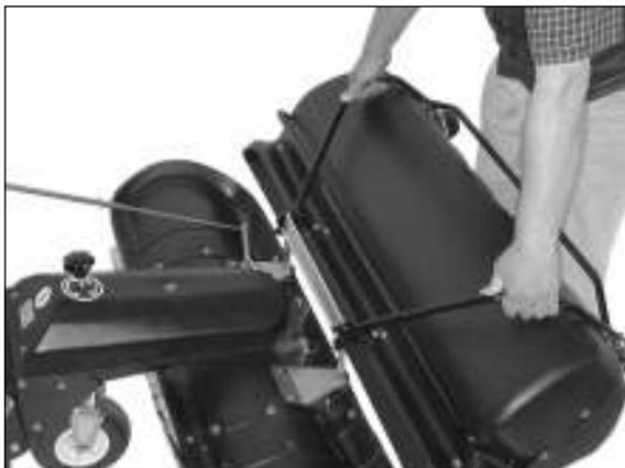
3) Placer le bac à déchets sur les barres de fixation et le déplacer vers le bas.
