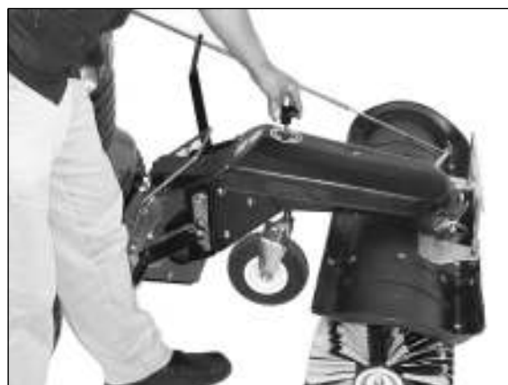
2) La rotella è regolabile in altezza ruotando la manopola.
