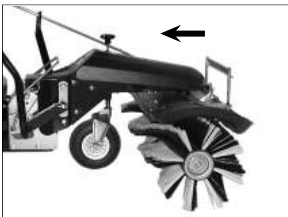
1) Sopra la rotella si trova la manopola per la regolazione della pressione delle spazzole.
