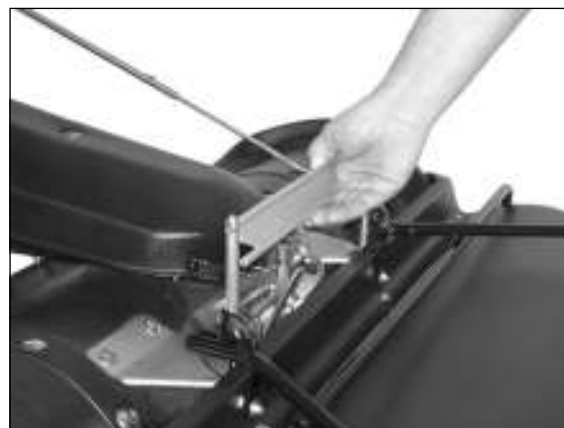
6) Contenitore di raccolta dei rifiuti bloccato.
