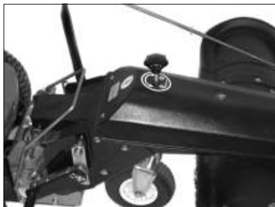
3) Pressione ottimale delle spazzole: Abbassare la spazzola fino a sfiorare il suolo. Poi effettuare ancora tre giri in senso antiorario nella direzione della freccia (-).
