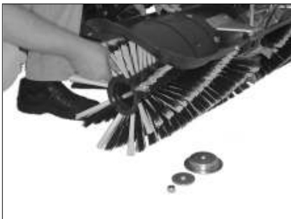
8) Schuif de linkerveegborstel op de as. Neem hierbij de eerdere montageaanwijzingen in acht.
