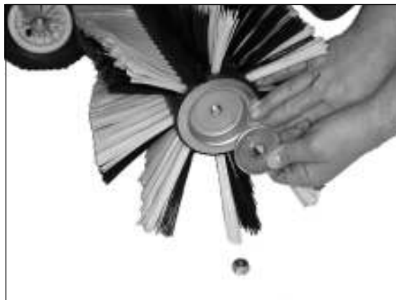
9) Nadat beide borstels zijn geplaatst, schuift u de sluitring en de kap op de as.
