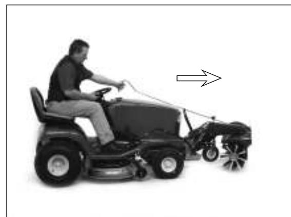
4) Durch Drücken an der Bedienstange verändert sich die Wurfrichtung nach rechts. Lassen Sie die Stange wieder sicher einrasten.
