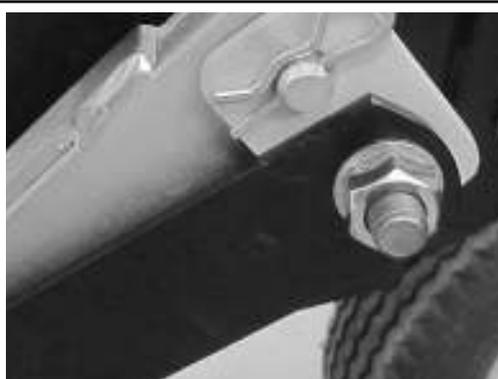
Korrekt montiertes Gestänge.
