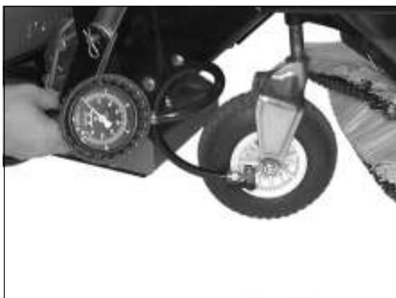
Stützrad: 2 bar. Bei Kopfsteinpflaster kann der Luftdruck auf 1,5 bar gesenkt werden.
