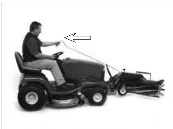
3) Durch Ziehen an der Bedienstange verändert sich die Wurfrichtung nach links. Lassen Sie die Stange wieder sicher einrasten.
