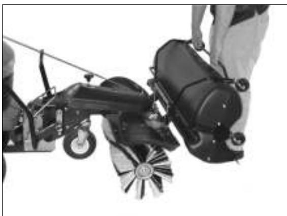
1) Am vorderen Kehrgutbehälterrahmen anheben.
