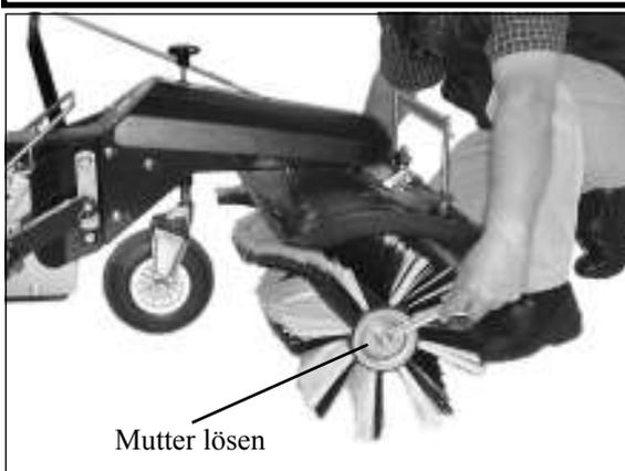
1) Mutter an der linken Kkehrbürste mit einem 19er-Ring-Maulschlüssel lösen (Mutter der anderen Kkehrbürste mit einem weiteren 19er-Ring-Maulschlüssel festhalten).
