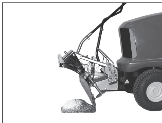
2) Räumschild-Unterkante schwenkt nach hinten. Sicherheits- Klappmechanismus ausgerastet.
