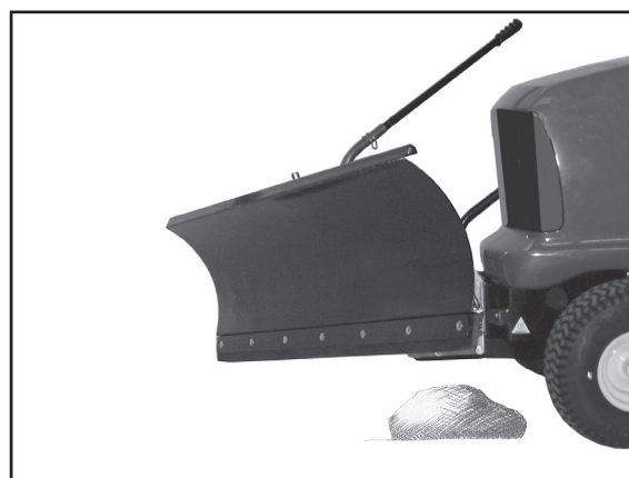
4) Die Schwenkvorrichtung wird frei, das Räumschild weicht dem Hindernis aus.
