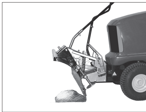
2) Le bord inférieur de la lame pivote vers l'arrière. Mécanisme de rabattement de sécurité déclenché.
