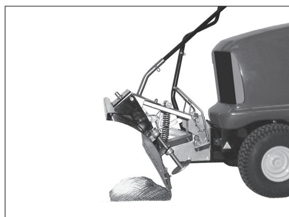
2) Il bordo inferiore della pala ruota indietro. Meccanismo di sicurezza disinnestato
