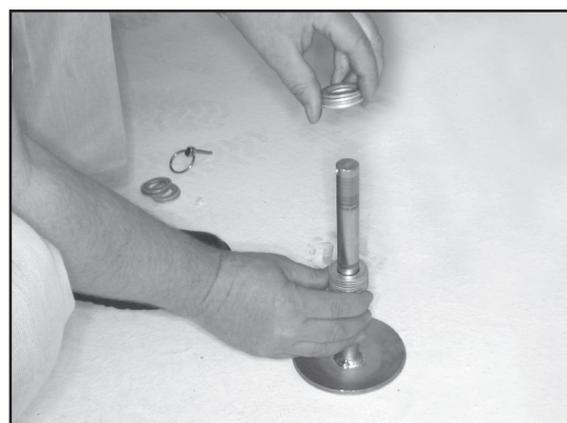
4) La regolazione in altezza si effettua utilizzando il numero necessario di rondelle.
