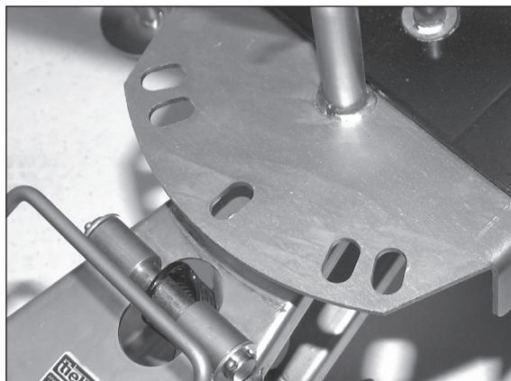
2) Piastra di arresto a 5 posizioni. Per cambiare posizione occorre sollevare l'asta di comando.
