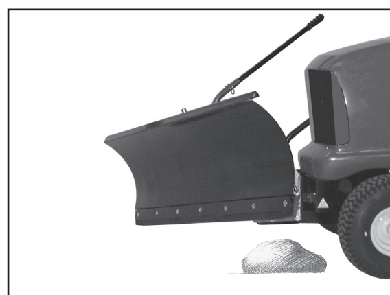
4) De zwenkinrichting komt vrij. De sneeuwschuiver ontwijkt het obstakel.
