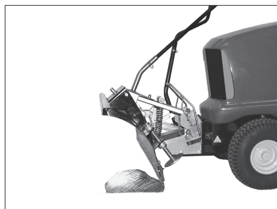
2) De onderkant van de sneeuwschuiver klapt terug. Het veiligheidsklapmechanisme wordt geactiveerd.
