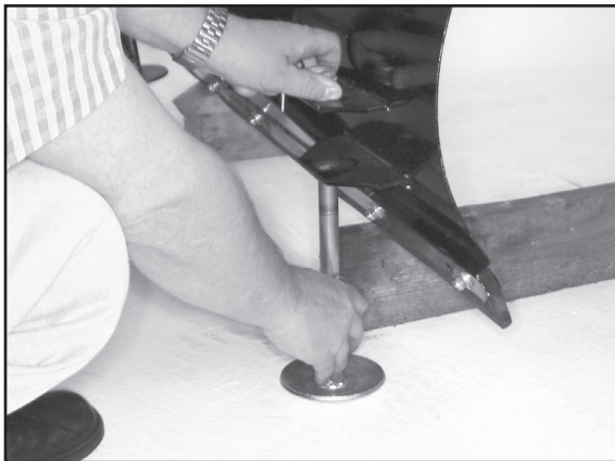
3) Trek het rechterijzer uit de schuiver.
